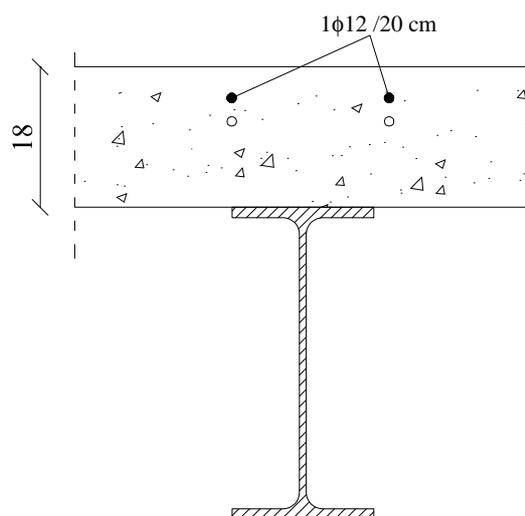
Figura 2: sezione trasversale della trave (IPE 400)
